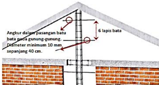
Gambar 3. 28 Hubungan Antara Tulangan Bingkai Gunung-Gunung/Ampig dengan Tulangan Kolom dan Balok Keliling/ Ring
