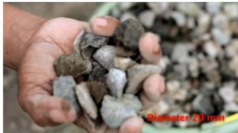
Gambar 3. 4 Diameter Kerikil yang Baik untuk Campuran Beton
