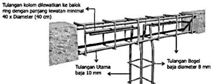
Gambar 3. 26 Hubungan Antara Kolom dengan Balok Keliling/Ring
