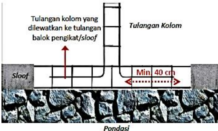
Gambar 3. 23 Detail Hubungan Balok Pengikat/Sloof dengan Kolom
