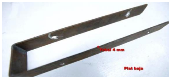
Gambar 3. 15 Pemasangan Plat Baja pada Kuda-Kuda Kayu
